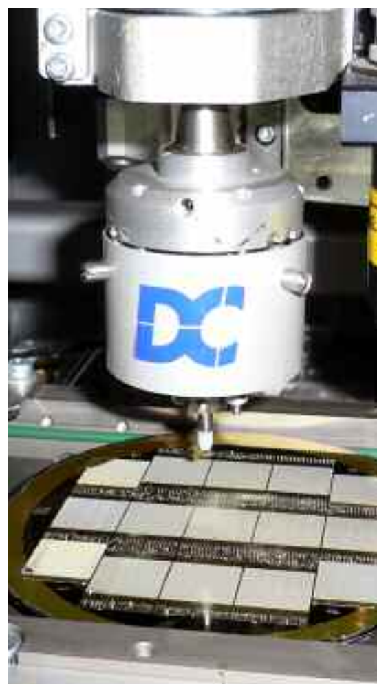
Acoblament de xips amb una màquina DATACON.
