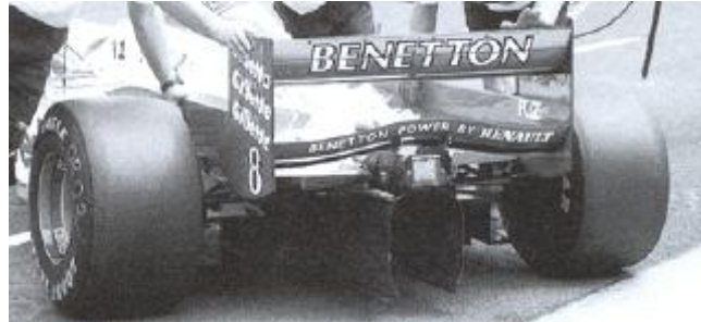
Figura 3.5. Aleró posterior de doble pla.
