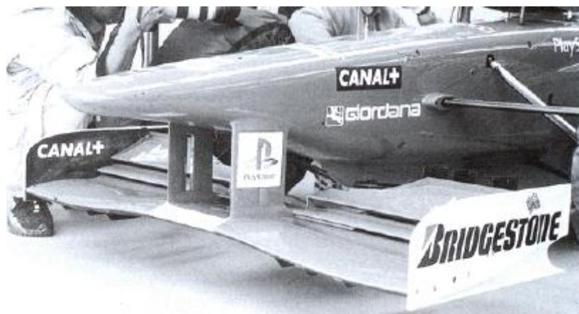
Figura 3.6. Aleró davanter de tres elements.
