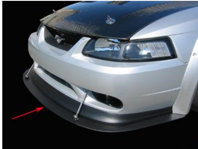
Figura 3.18. Exemple de divisor de flux.
