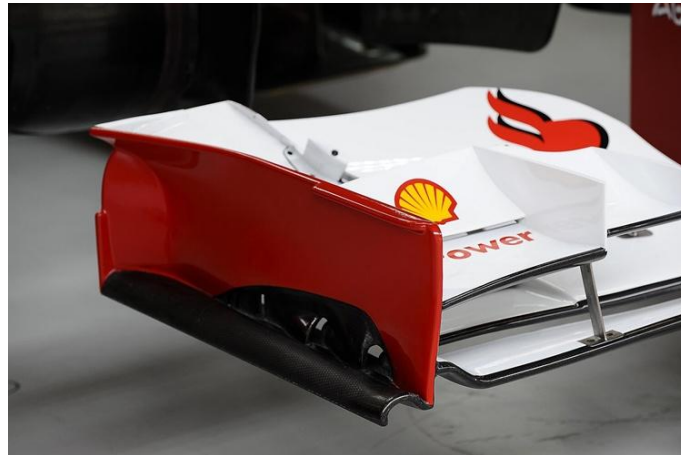
Figura 3.8. Derives de l'aleró davanter d'un Formula 1.
