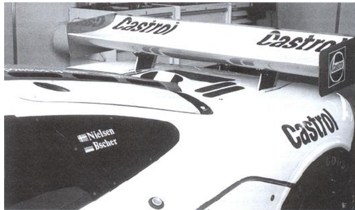
Figura 3.3. Aleró posterior d'un sol element.
