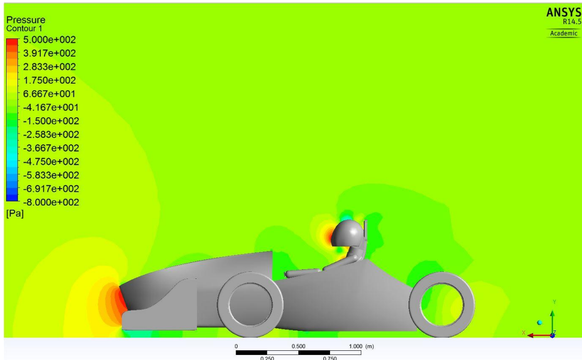
Figura 6.7. Pressions al voltant del vehicle amb aleró davanter en el pla de simetria.
