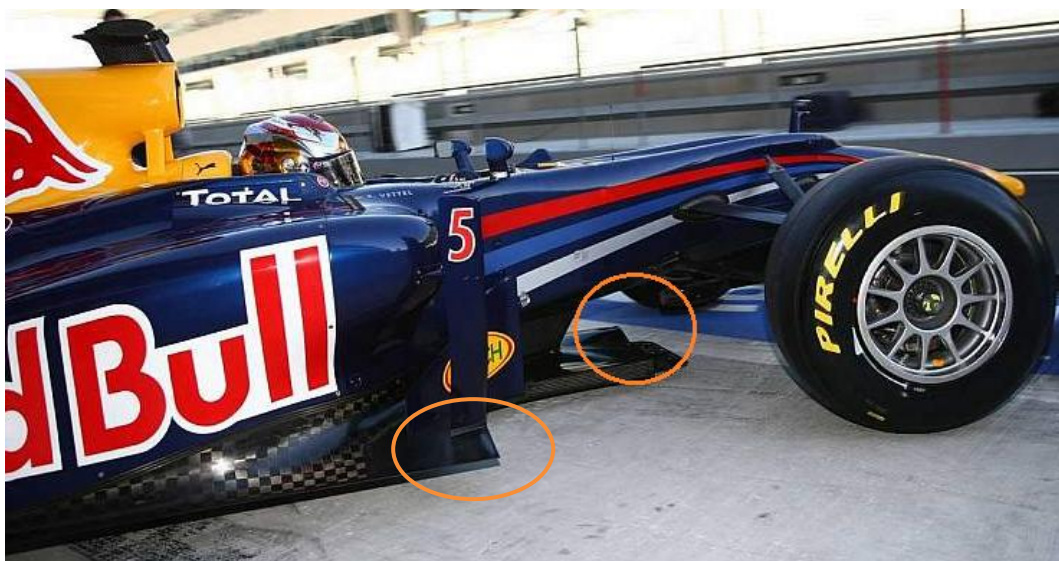
Figura 3.19. Divisors de flux en un Formula 1.
