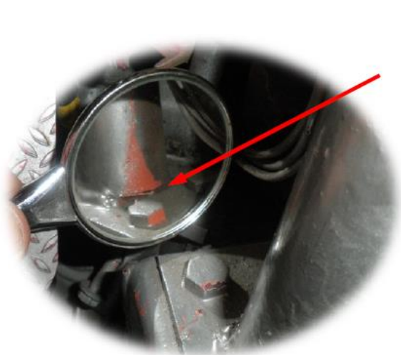
Figura A.4: tub no soldat durant tot el perímetre del tub
