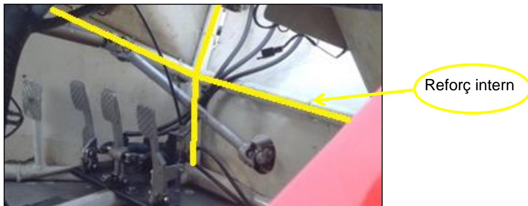
Figura C.14: Reforç intern d'un vehicle actual CM
