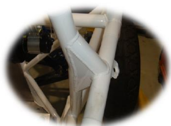
Figura A.2: Fixació mitjançant un peu amb placa de reforç
