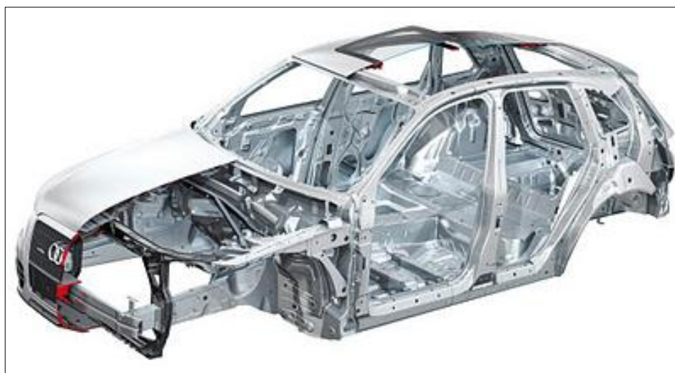
Figura B.2: Xassís monocasc o autoportant (Font: http://www.arpem.com/ )
