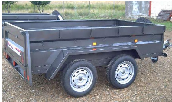
Il·lustració 7. Remolc de 2 eixos i 2000 kg de càrrega
