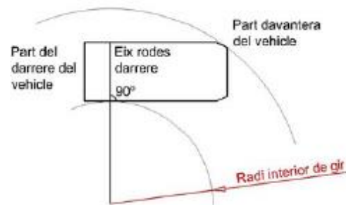
Figura: Radi interior de gir Font: Llei d'Equipaments Comercials
