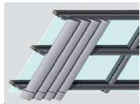
Sistema de lames orientables sota paviment de vidre. Font: Catàleg tècnic "TECHNAL".
