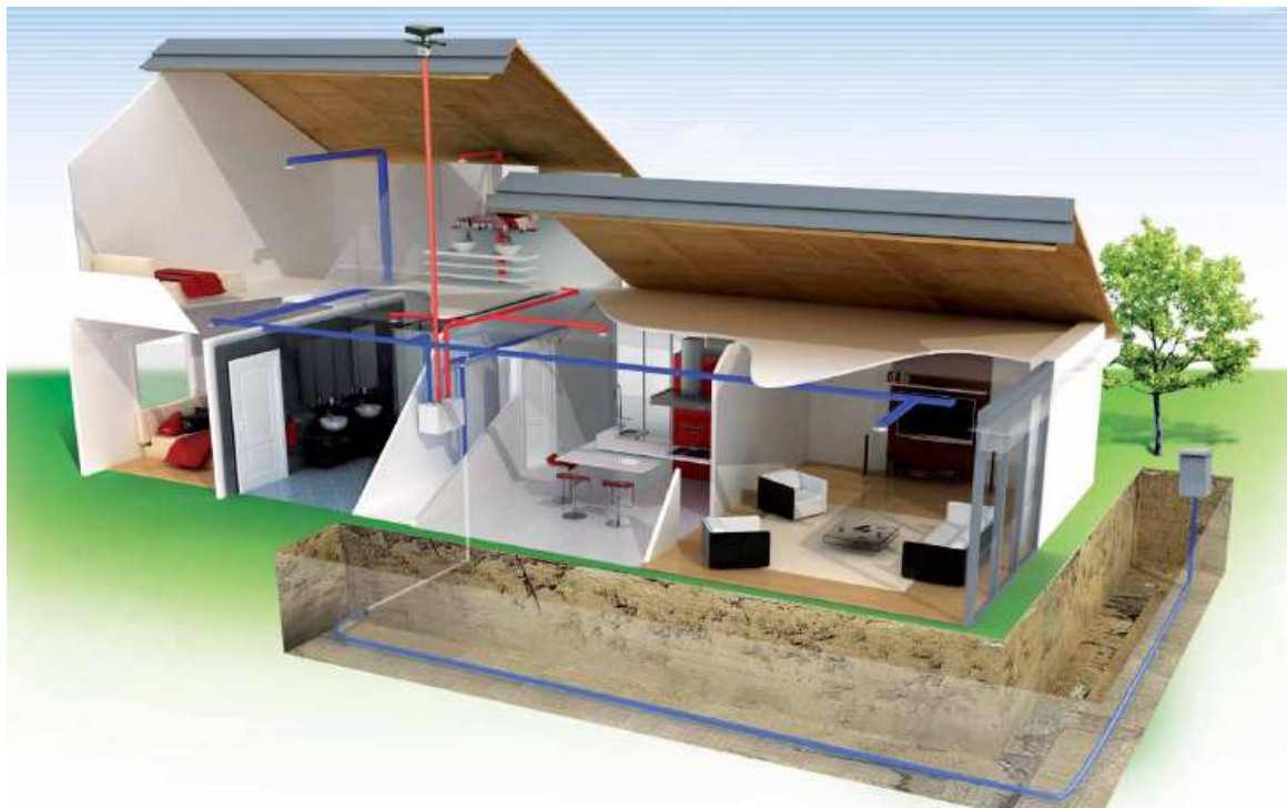
Esquema instal·lació de ventilació amb pou canadenc i recuperador de calor. Font: Catàleg "SIBER VENTILACIÓN"
