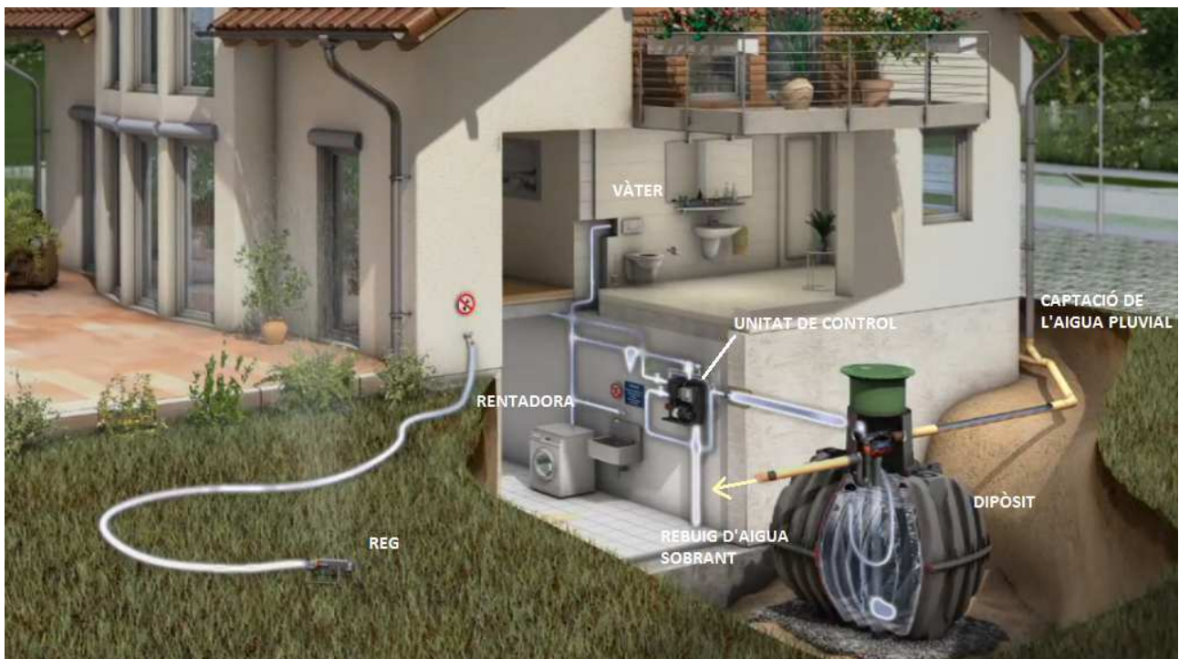
Exemple d'una instal·lació d'aprofitament d'aigües pluvials en una vivenda unifamiliar. Font: www.grafiberica.com .
