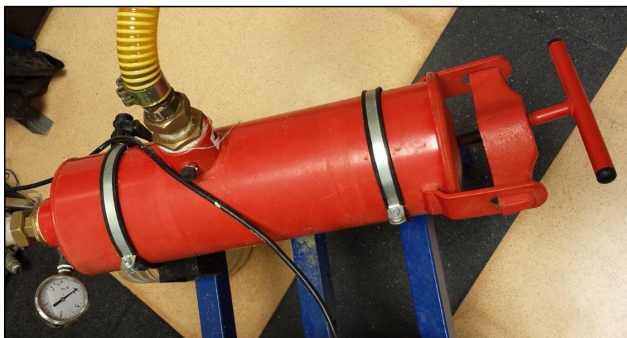
Figura 3.11. Filtre de malles.
