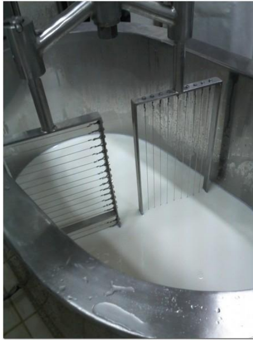
Figura IV. 3. Operació de tallat de la quallada mitjançant lires mecàniques mixtes. Font: Mahaut, et al., 2004.
