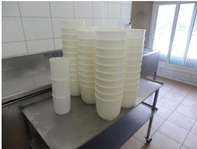
Figura IV. 4. Diferents tipus de motlles microperforats per tal de facilitar l'eliminació del sèrum. Font: Elaboració pròpia.
