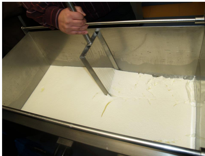
Figura IV. 2. Operació de tallat de la quallada mitjançant lires manuals verticals. Font: Mahaut, et al., 2004.
