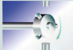
Detección de tornillos de ajuste en la rueda para control de velocidad o dirección
