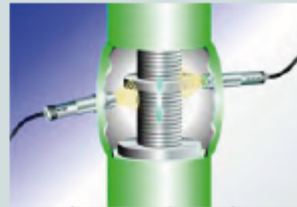
Detección de la posición de la válvula (totalmente abierta o cerrada)
