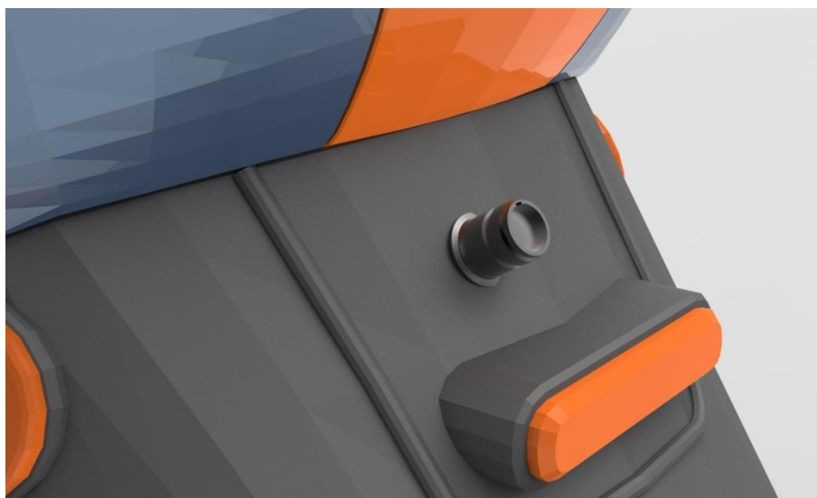
Figura 34: Connector circular fixat al porta-matrícules
