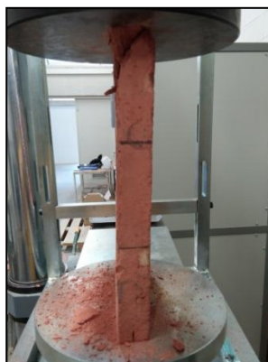
Fotografia 55 Patró trencament B2.5
