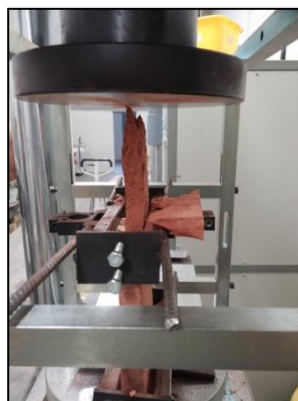
Fotografia 48 Patró trencament B1.3
