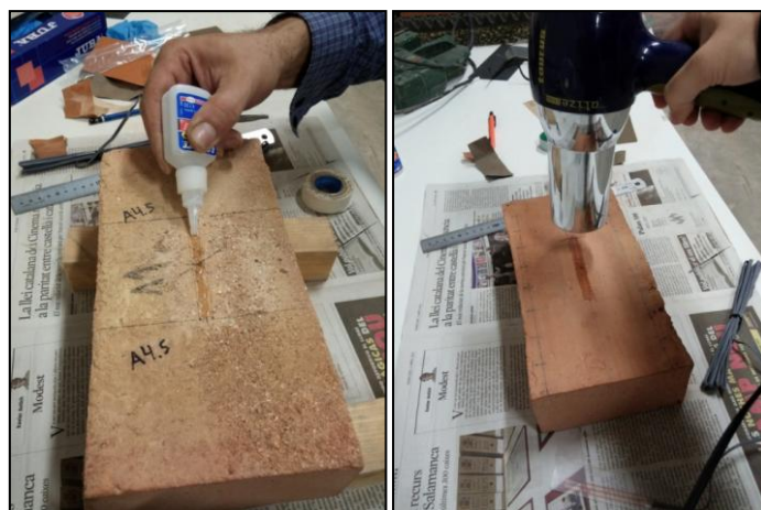
Fotografia 26 Capa de cola adhesiva
