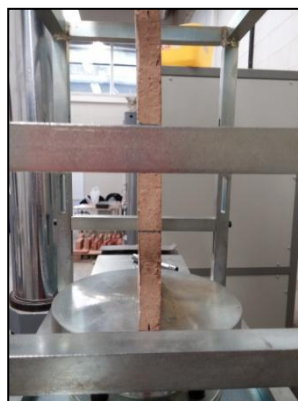
Fotografia 32 Patró de trencament A1.2
