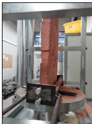
Fotografia 46 Patró trencament B1.1
