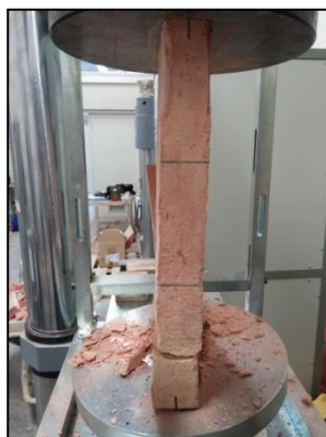
Fotografia 38 Patró trencament A2.3
