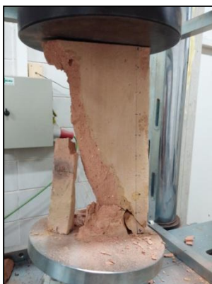
Fotografia 36 Patró de trencament A2.1
