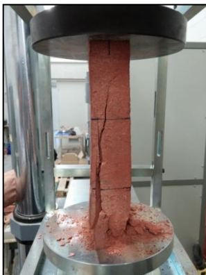
Fotografia 58 Patró trencament B3.3
