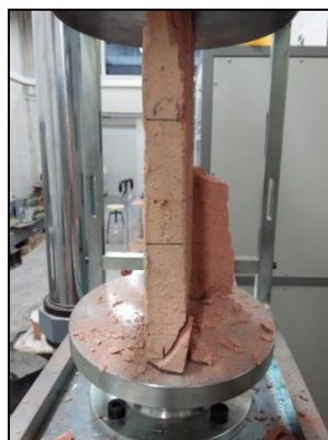
Fotografia 36 Patró de trencament A2.1
