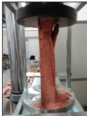
Fotografia 57 Patró trencament B3.2
