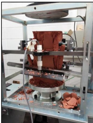
Fotografia 44 Patró trencament A4.4
