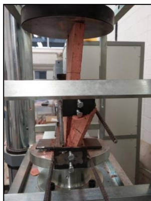
Fotografia 50 Patró trencament B1.5
