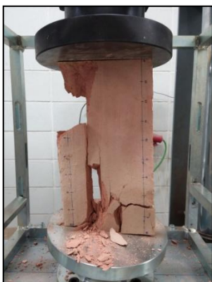
Fotografia 38 Patró trencament A2.3
