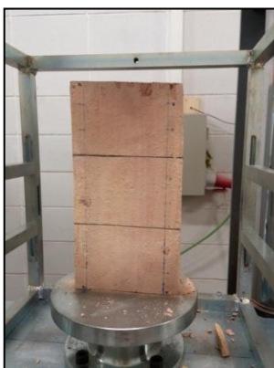
Fotografia 33 Patró de trencament A1.3
