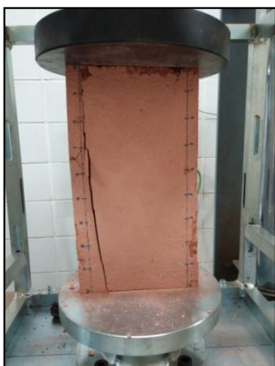
Fotografia 52 Patró trencament B2.2
