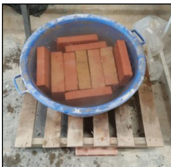
Fotografia 12 Condicionament per immersió
