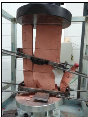
Fotografia 50 Patró trencament B1.5
