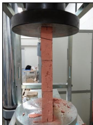
Fotografia 54 Patró trencament B2.4
