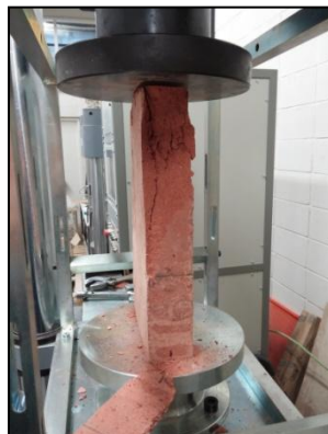
Fotografia 65 Patró trencament C3.5
