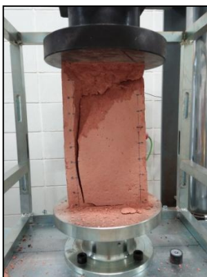
Fotografia 55 Patró trencament B2.5
