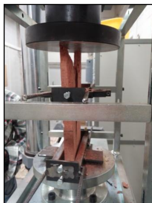
Fotografia 49 Patró trencament B1.4
