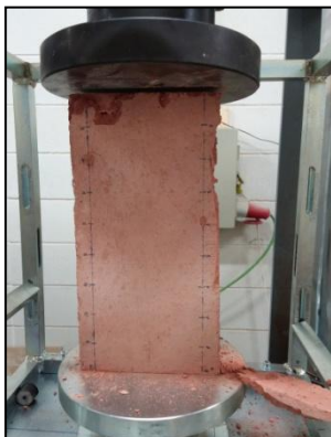
Fotografia 65 Patró trencament C3.5
