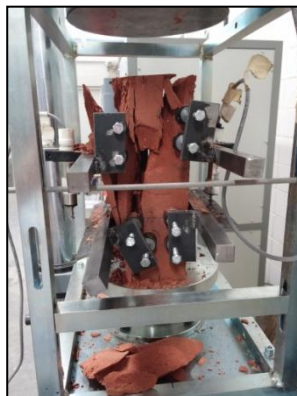
Fotografia 44 Patró trencament A4.4
