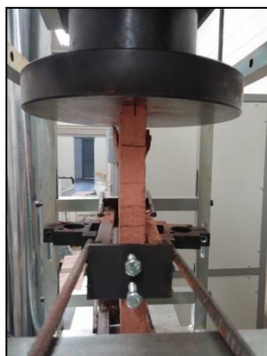
Fotografia 47 Patró trencament B1.2
