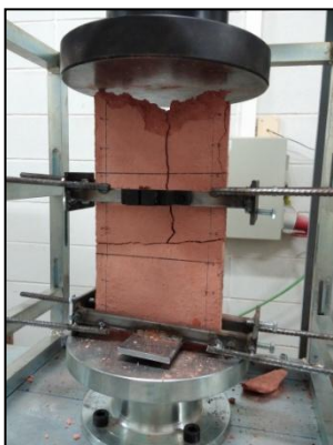
Fotografia 46 Patró trencament B1.1
