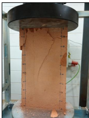
Fotografia 54 Patró trencament B2.4
