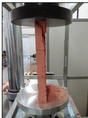
Fotografia 52 Patró trencament B2.2
