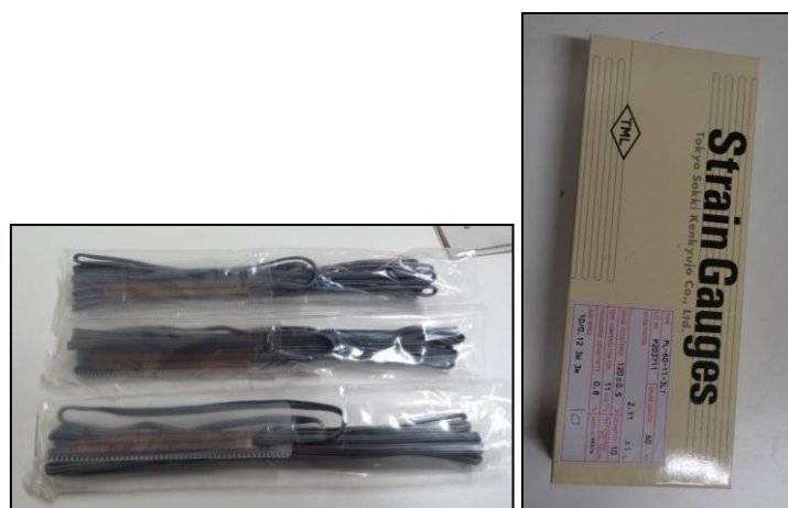
Fotografia 23 Galgues de formigó
