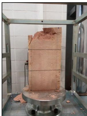
Fotografia 35 Patró de trencament A1.5
