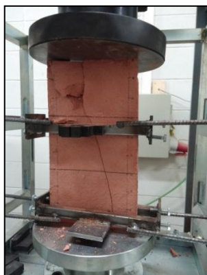
Fotografia 49 Patró trencament B1.4
