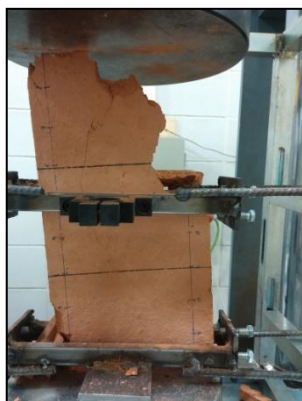
Fotografia 48 Patró trencament B1.3
