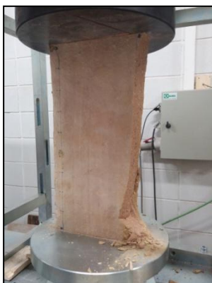
Fotografia 40 Patró trencament A2.5
