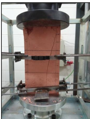
Fotografia 47 Patró trencament B1.2
