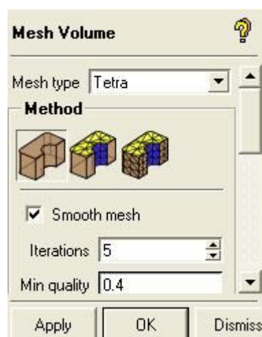
Figura G.15 Diàleg per definir el tipus d'elements per la malla
