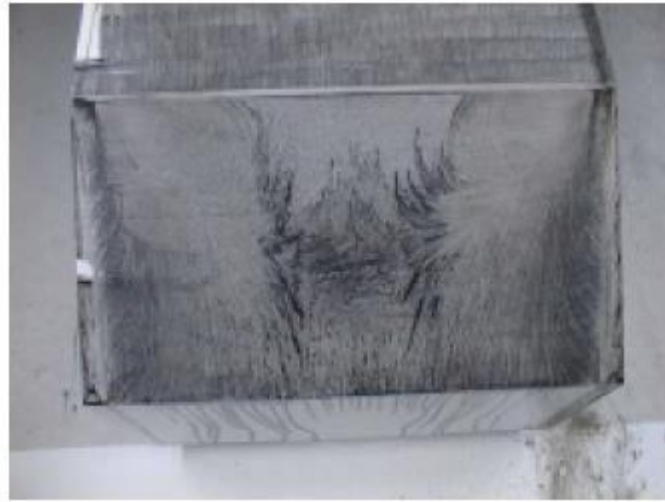
Figura A.4. Visualització del flux de raig d'oli/sutge de la part posterior del cos d'Ahmed per un angle d'inclinació de 25° (Lienhart et al, 2000).
