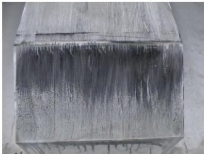
Figura A.5. Visualització del flux de raig d'oli/sutge de la part posterior del cos d'Ahmed per un angle d'inclinació de 35° (Lienhart et al, 2000).
