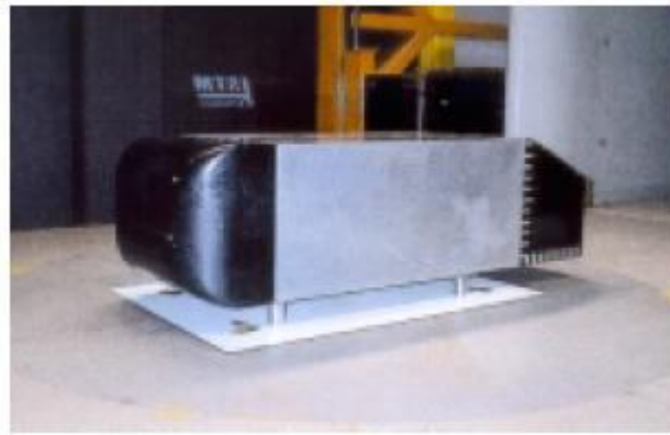
Figura A.3. Fotografia del cos d'Ahmed muntant en el túnel de vent de baixa velocitat LSTM (Lienhart et al, 2000).
