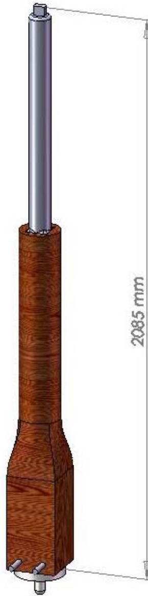
Figura 7: Eix principal que uneix el rodet (situat a la part inferior) amb la mola (a la part superior).
