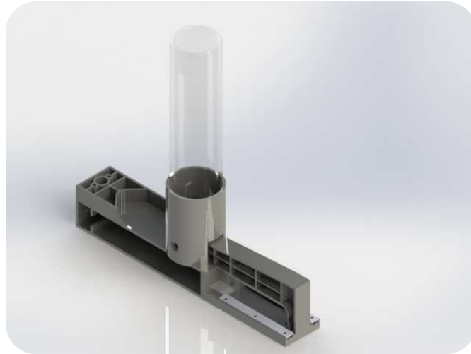
Figura 2: vista isomètrica del dispensador de cilindres vermells
