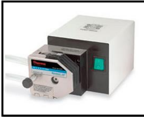
Figura 14: Bomba peristàtica utilitzada
