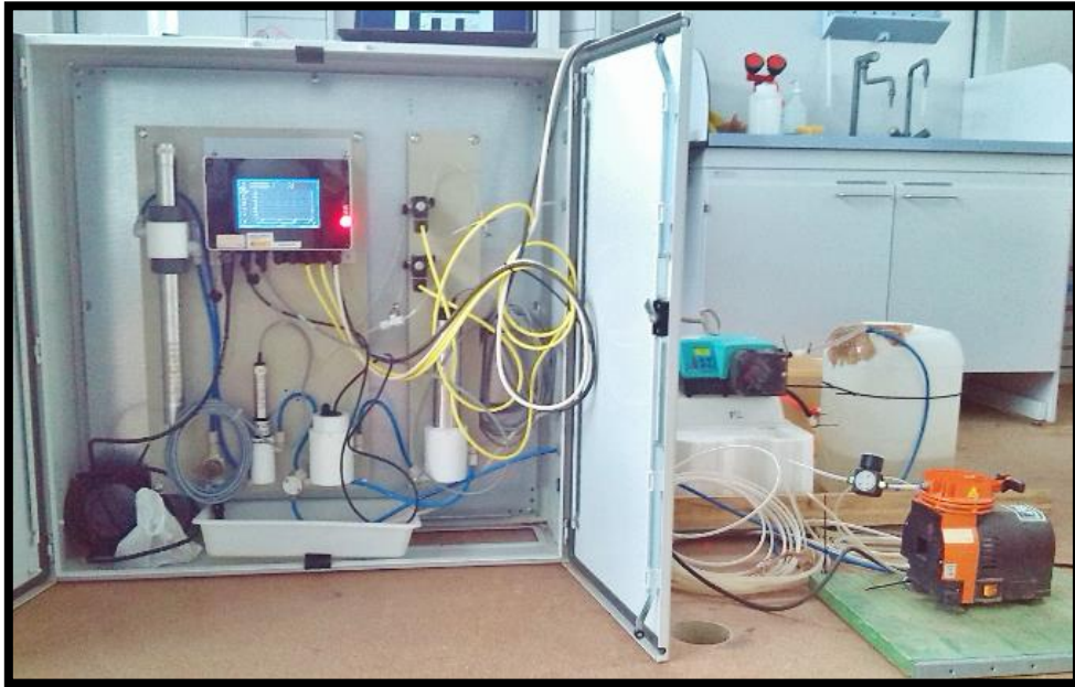
Figura 22: Prova del funcionament dels sensors al laboratori
