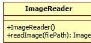
Figura 8.6: Fragment del diagrama de classe referent a ImageReader.
