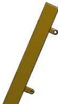
Figura 3.2. Orelles de la rampa.
