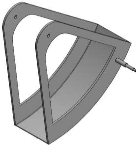
Figura 5.6. Extensió de la rampa.
