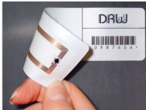
Figura 5 – Detall de com l'integrat queda adherit a l'etiqueta
