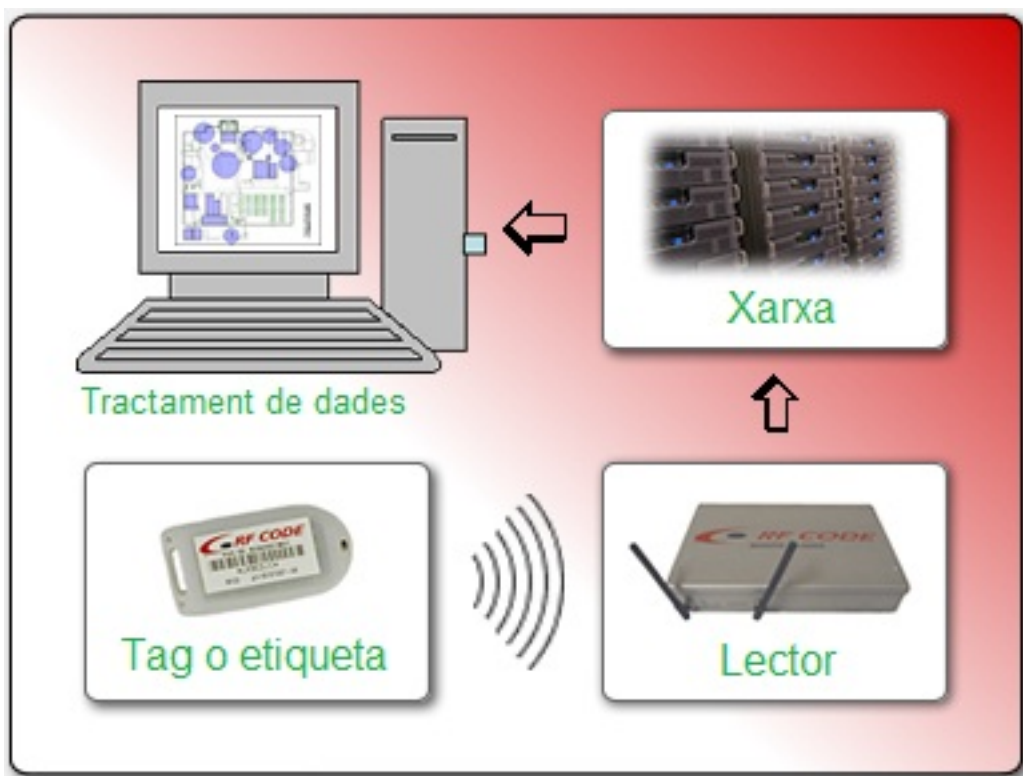
Figura 1 – Esquema de funcionament del procés de detecció amb RFID Font: RF CODE
