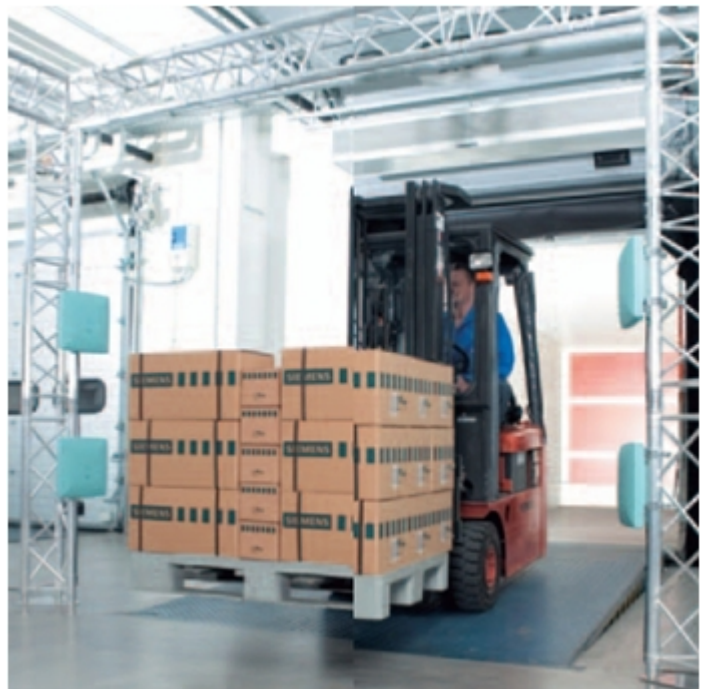
Figura 3 – Pòrtic de detecció que permet identificar la càrrega del palet
