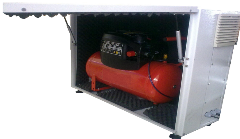
Figura 9 – Exemple de muntatge del compressor
