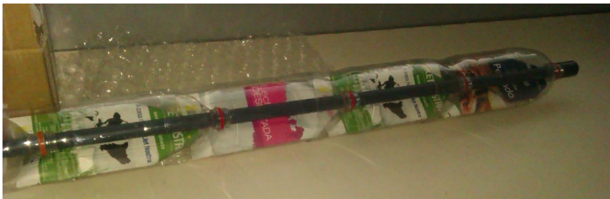
Figura 7. Representació del muntatge amb tubs i tetrabriks sense pintar.
