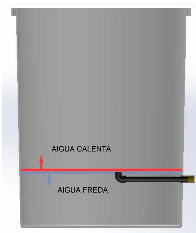
Figura 18. Representació del guiador i com realitza la seva funció
