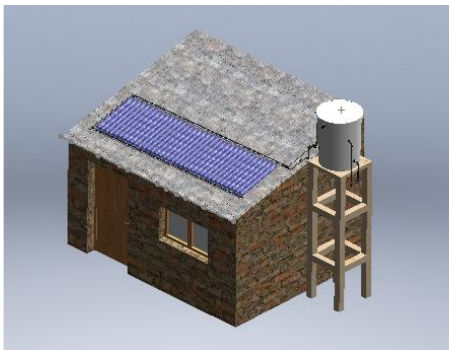
Figura 9. Simulació de l'habitacle amb el sistema instal·lat.
