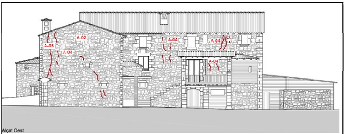
Imatge.B- 23 Lesions a edifici principal, façana Oest / FONT: (els Autors, 2013)
