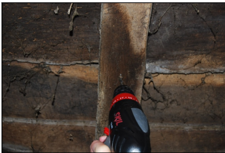
Fot.B- 50 Assaig de resistència al centre de la biga amb un trepan / FONT: (els Autors, 2013)
