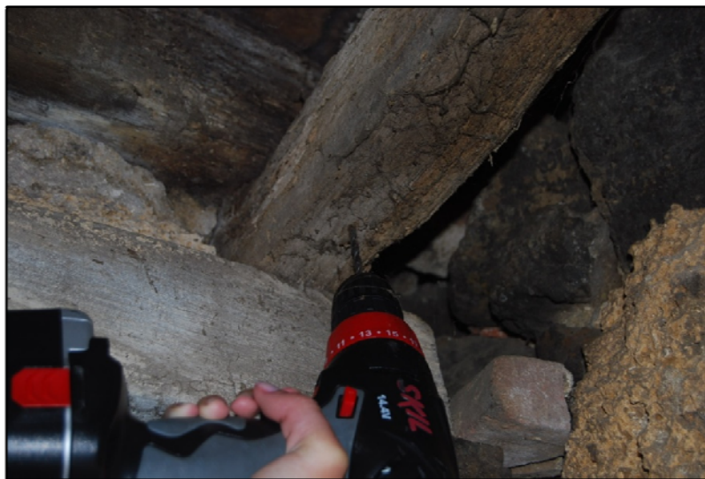
Fot.B- 51 Assaig de resistència al cap de la biga amb un trepan/ FONT: (els Autors, 2013)
