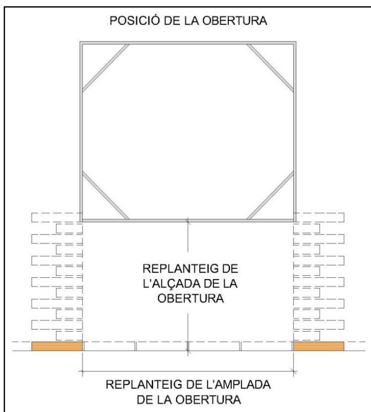
Figura 4.2 - Replanteig de la obertura en el tancament
