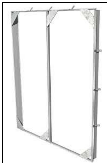
Figura 4.3 - Col·locació del premarc
