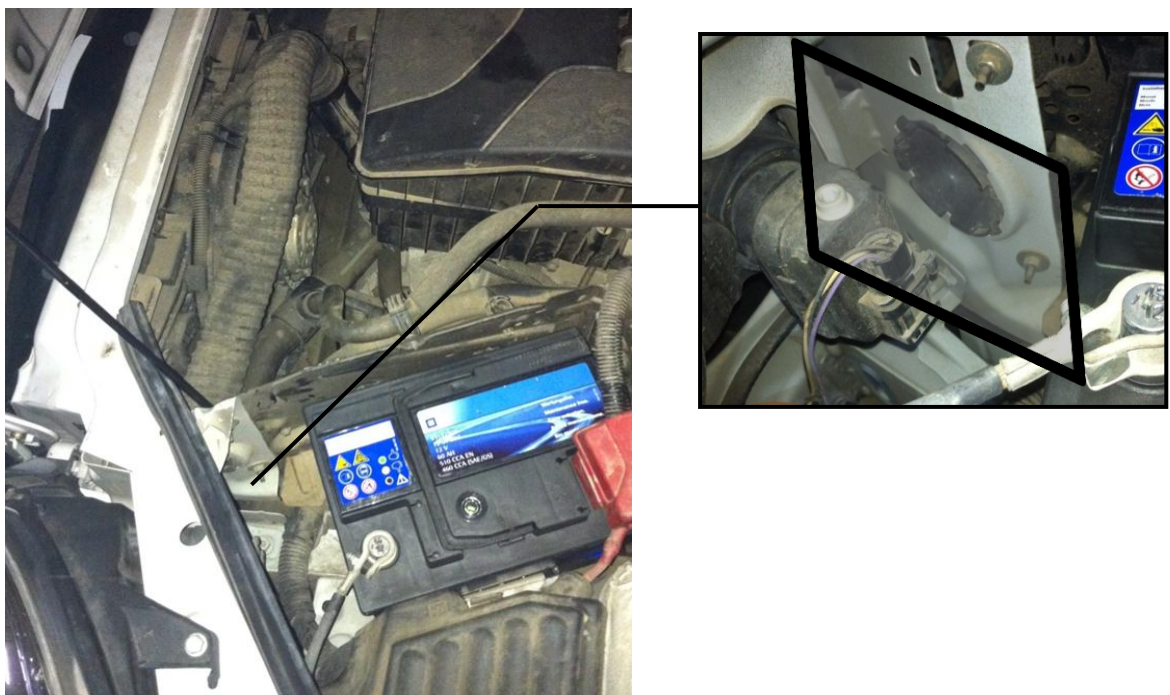
Figura 39: Ubicació de l'evaporador
