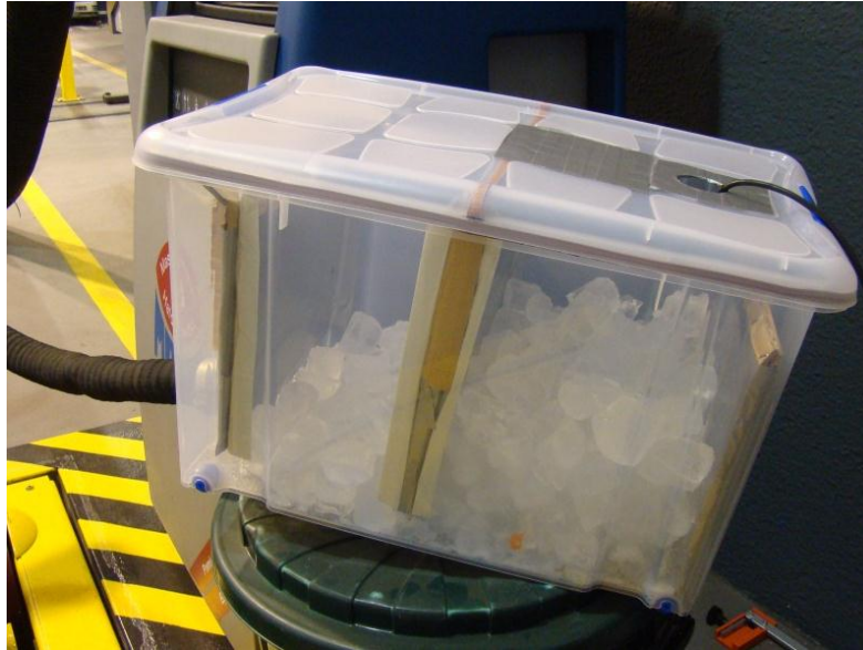
Figura 17: Sistema utilitzat per refrigerar l'aire durant les proves
