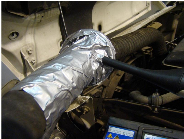
Figura 14: Posició sensor de temperatura i humitat a l'admissió
