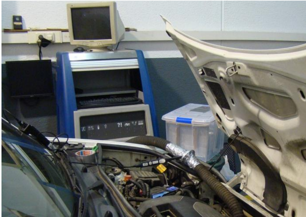
Figura 22: Muntatge entrada aire refrigerat
