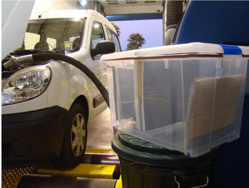
Figura 19: Muntatge prova sense sobrealimentació
