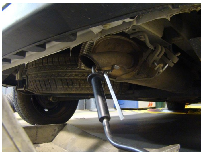
Figura 16: Sonda anàlisi fums d'escapament
