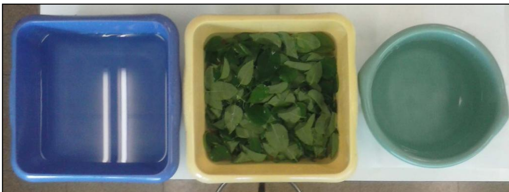
Figura 2.3 Procediment de neteja de les fulles. Cubells amb aigua, solució de lleixiu al 5% i aigua destil·lada.
