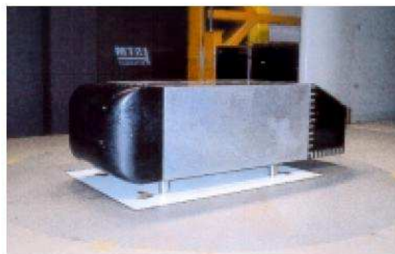
Figura 151. Fotografia del cos d'Ahmed muntat en el túnel de vent.
