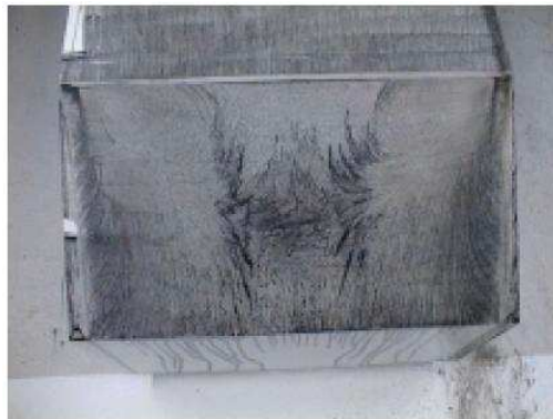
Figura 152. Visualització del flux a la part posterior del cos d'Ahmed a 25°.
