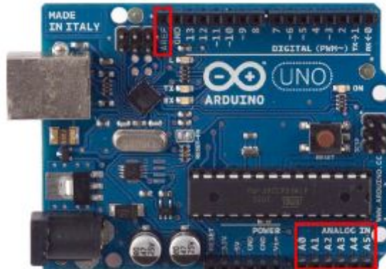
Figura D.6 Entrades i sortides analògiques de l'Arduino Uno.
