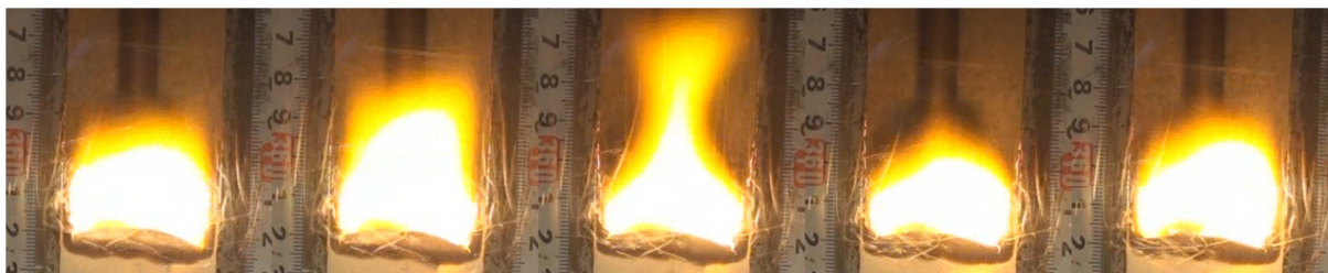
Figura 22. Seqüència de 0,5 segons on s'observa la fluctuació de la flama.
