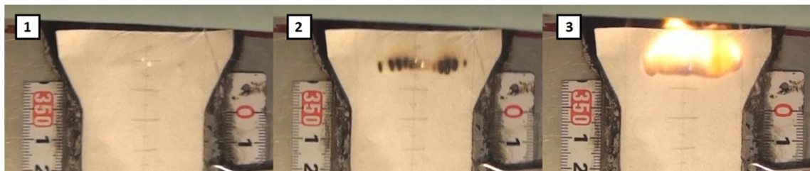
Figura 2. Fases del procés de generació de la flama: 1 – Estat inicial. 2 – Piròlisi. 3 – Combustió.
