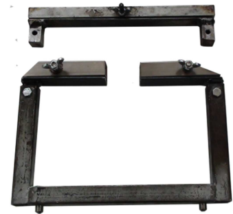
Figura 11. Suports (1) original i (2) modificat
