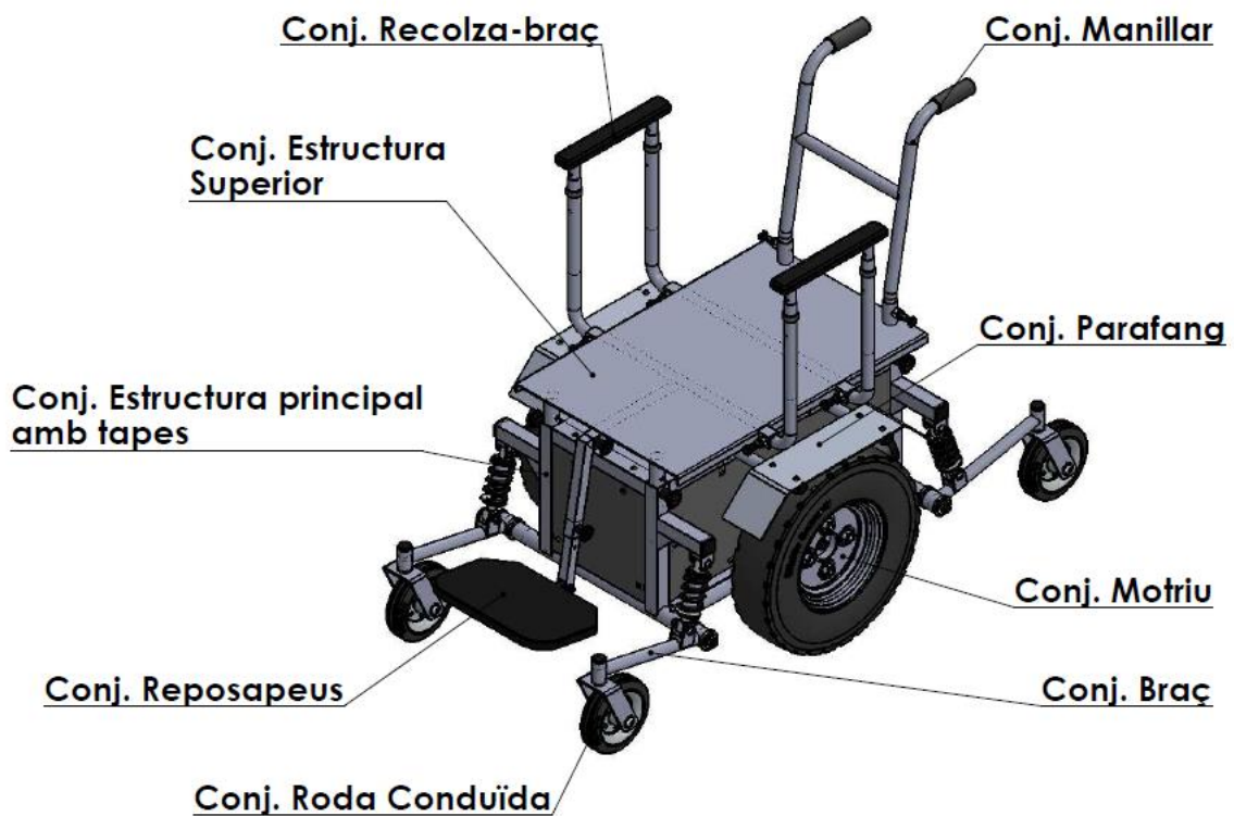
Figura EA-01. Cadira de rodes elèctrica amb tots els subconjunts que la componen.
