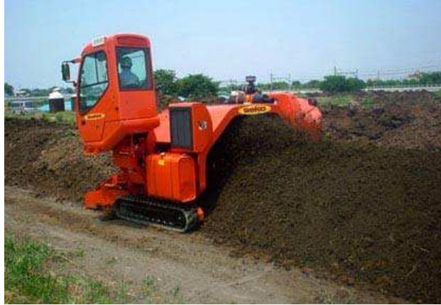
Figura 4.2: Volteig d'una pila amb una màquina voltejadora. Font: empresa SEKOSPA
