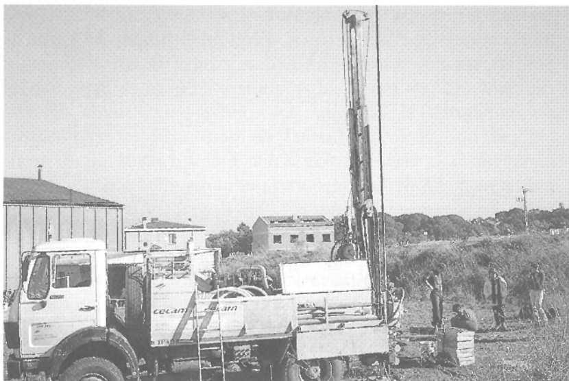
Perforació del terreny mitjançant un sondatge mecànic. (Foto: Arxiu UG)
