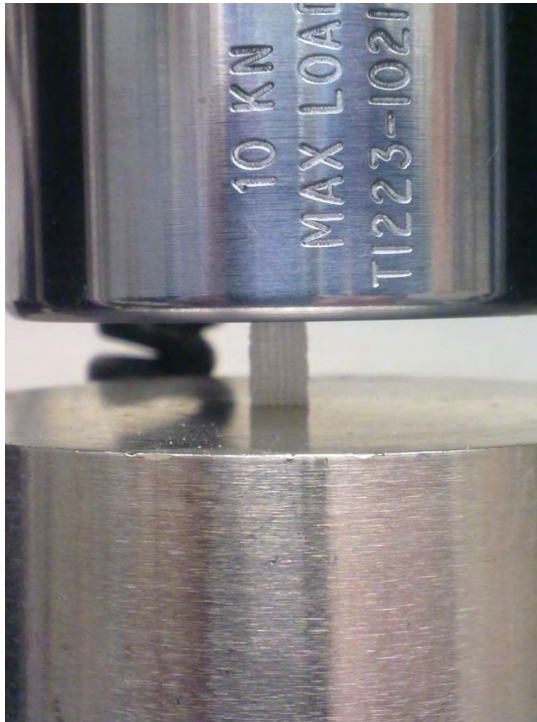
Figura 6.1: Scaffold 3D submetido à compressão utilizando uma INSTRON 5566 equipada com uma célula de carga de 10 kN.
