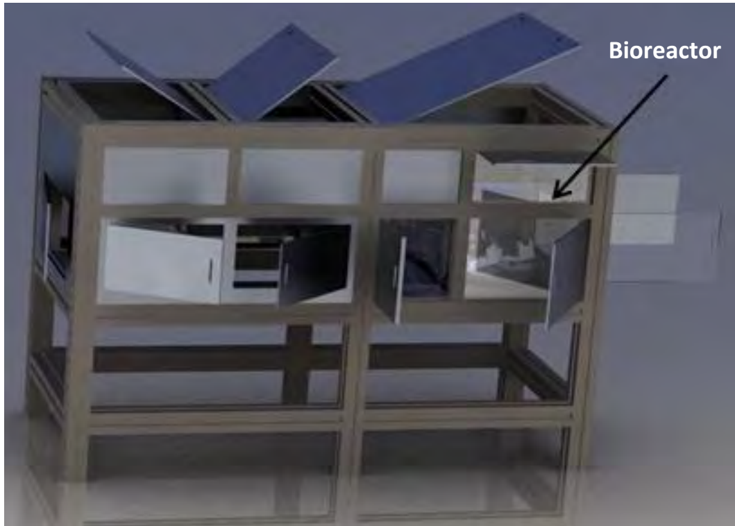
Figura 4.4: Representação do acoplamento do bioreactor multifuncional ao sistema BioCell Printing.
