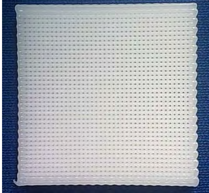
Figura 4.20: Scaffold em PCL com dimensões de 30 mm x 30 mm x 8mm.
