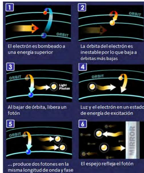
Figura 2.9: Proceso de obtención del haz láser.
