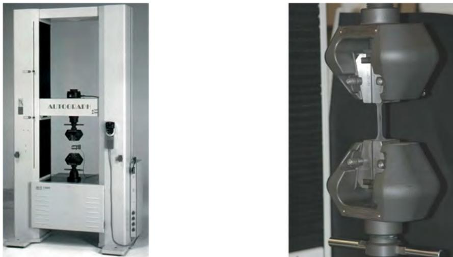
Figura 4.10: Ensayo a tracción
