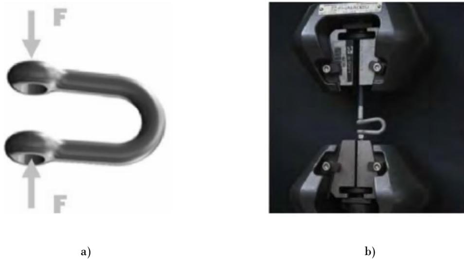
Figura 5.5: Ensayo mosquetón náutico a) esquema b) real
