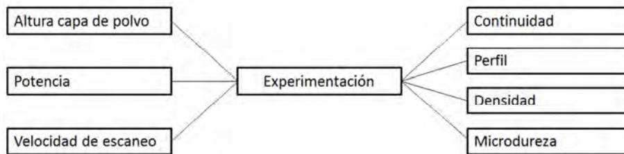
Figura 3.11: Parámetros de entrada y de salida.
