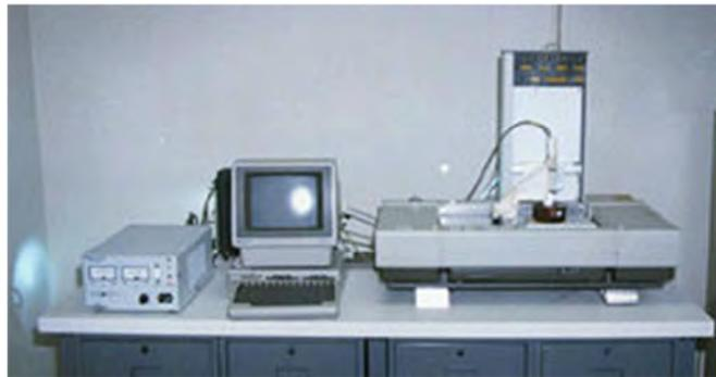
Figura 1.1: Primer sistema de estereolitografía. Fuente: (3D Systems)
