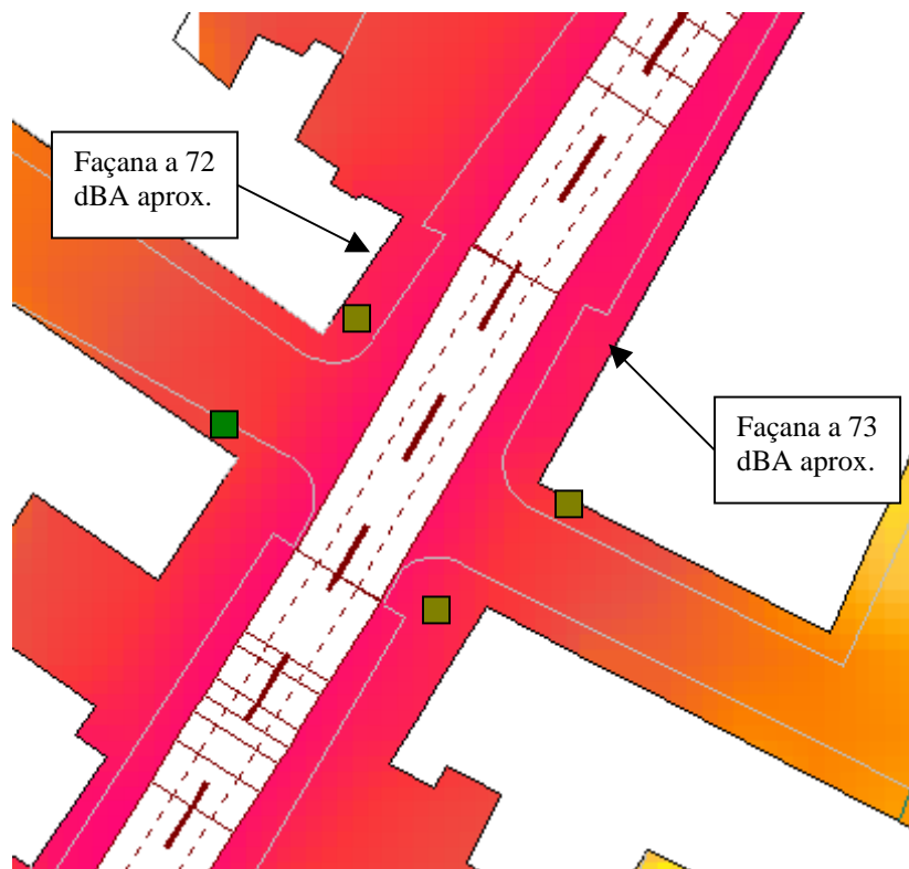
Figura 25. Mapa acústic d'un edifici de primera línia d'un tram amb semàfor
