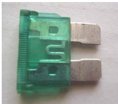
Figura 28.- Fusible de 40A para el Inversor Tripplite 375
