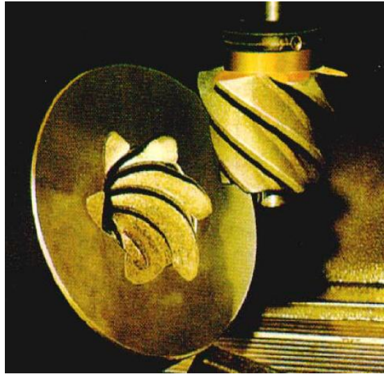
Figura 2.2. Exemple d'elèctrode i peça mecanitzada
