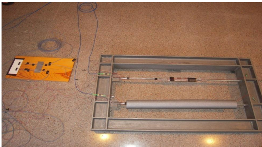
Figura 6.21 : Imatge del conjunt banda extensomètrica + circuit linealitzador.
