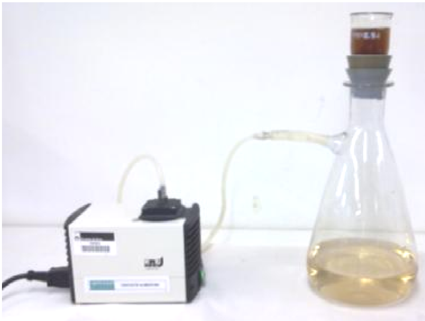
Figura 11: Filtratge amb plaques n°4
