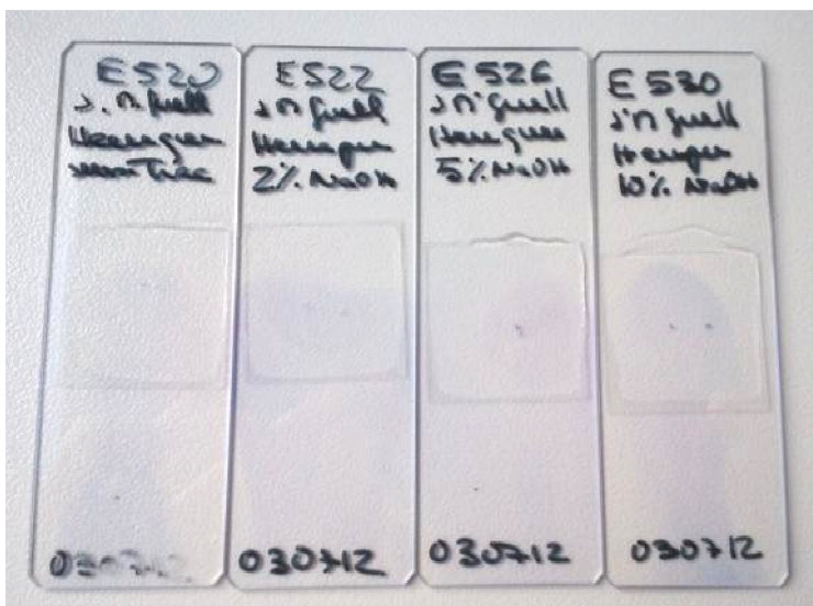
Figura 4: Platina de vidre amb mostres tallades
