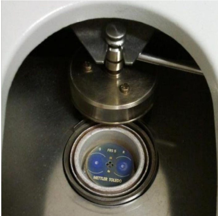
Figura 30: Ubicació del gresol dins el forn del DSC
