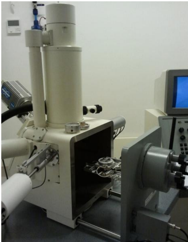
Figura 38: Microscopi elèctric de rastreig
