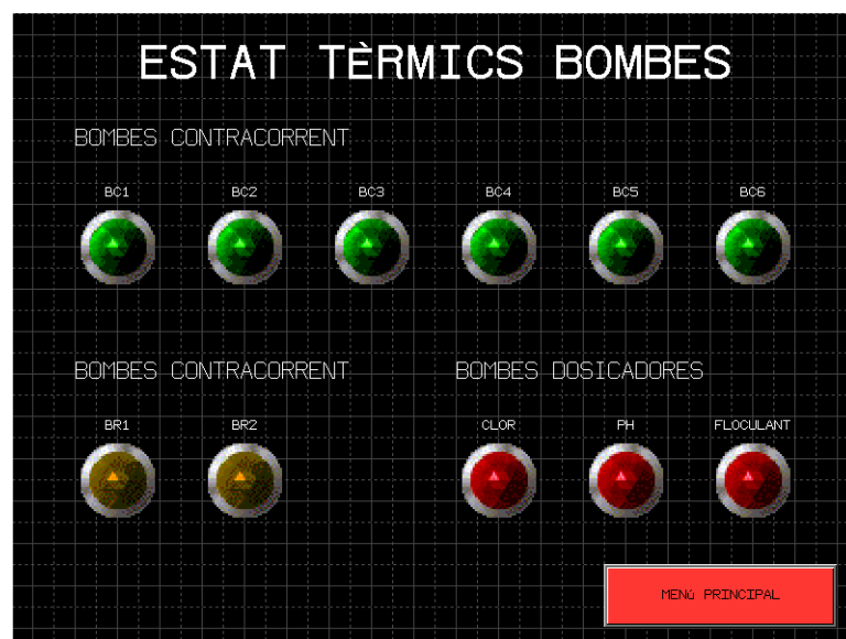
Figura 9. Panell manteniment-Estat dels tèrmics de les bombes
