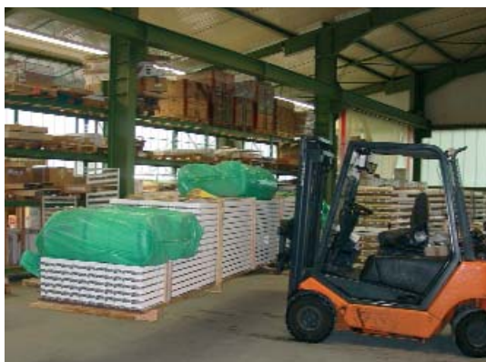
Toros mecánicos, con palas suficientemente largas para evitar el vuelco de la carga.
