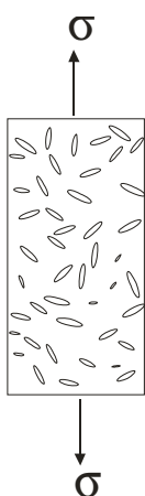
Figura 1.4. Una proveta de ciment està plena de porus i esquerdes.
