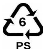
Figura 1. Codi per a la identificació genèrica dels plàstics d'envasos. Cada nombre va associat a un plàstic determinat: 1, PET; 2, HDPE; 3, V (PVC); 4, LDPE; 5, PP; 6, PS; 7, altres
