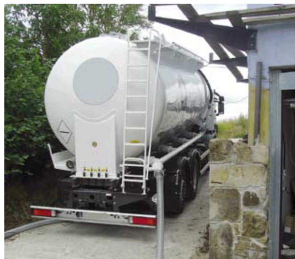
Figura 4 – Camió cisterna equipat amb sistema pneumàtic de descàrrega
