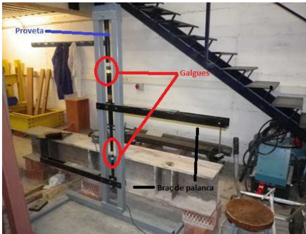
Figura 2.1: Muntatge antic de la pràctica de deformacions en bigues sotmeses a tracció i compressió
