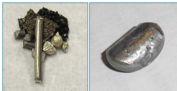
Figura 19. Abans i després del massís que s'ha obtingut amb l'Arc Melting
