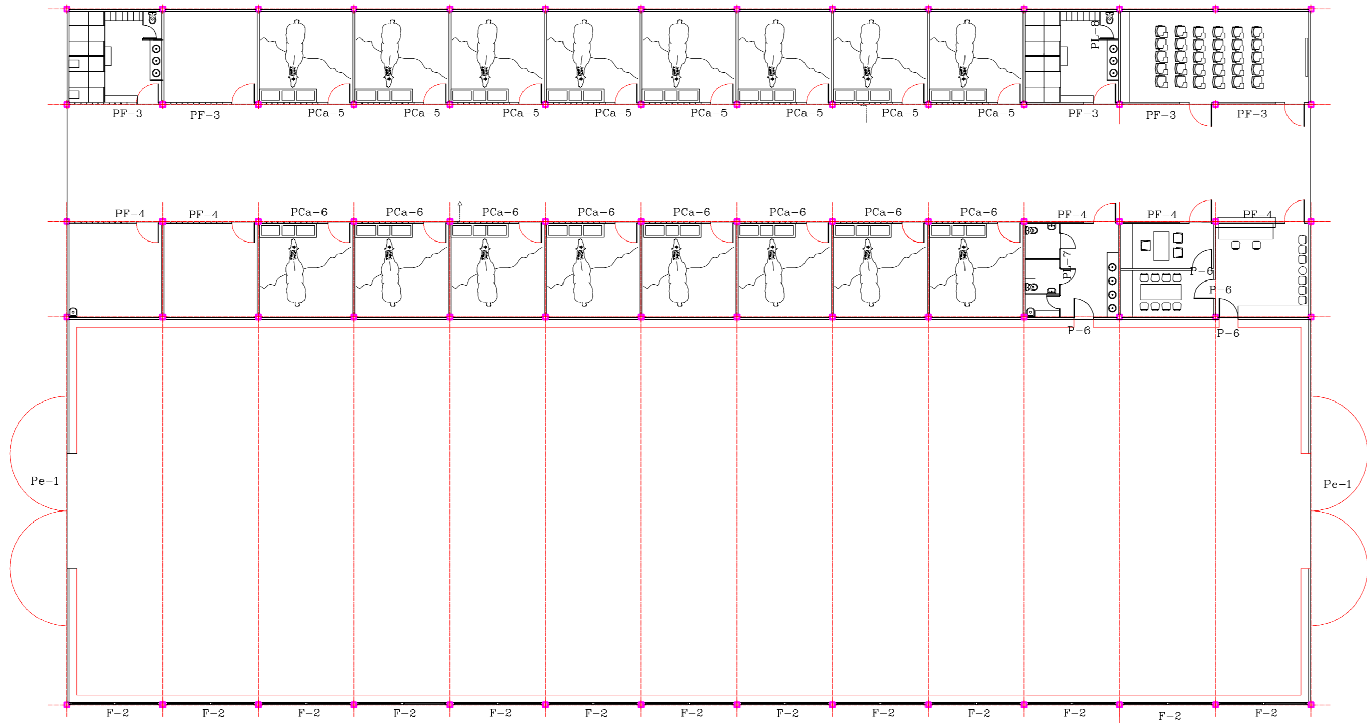
PLANTA ENUNERACIÓ DE FUSTERIA,
