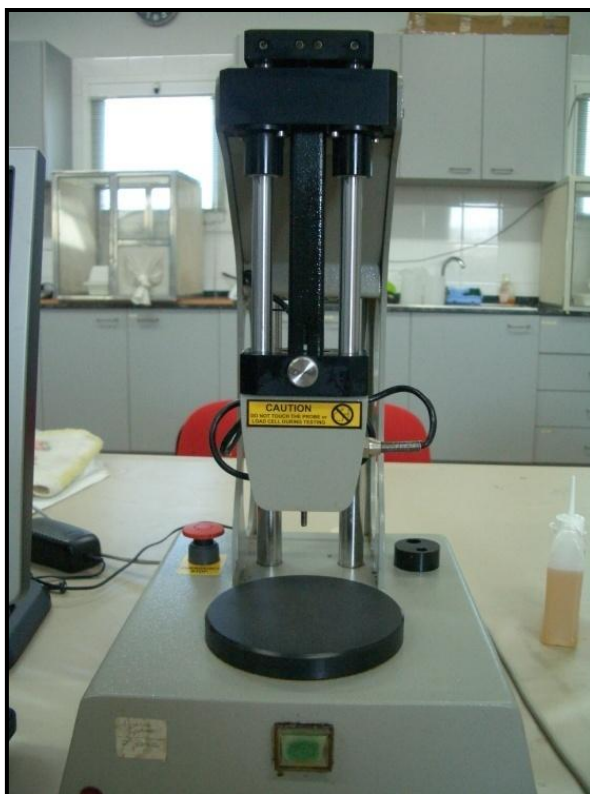
Figura 14. Imatge del Penetròmetre electrònic utilitzat per mesurar la fermesa dels fruits.
