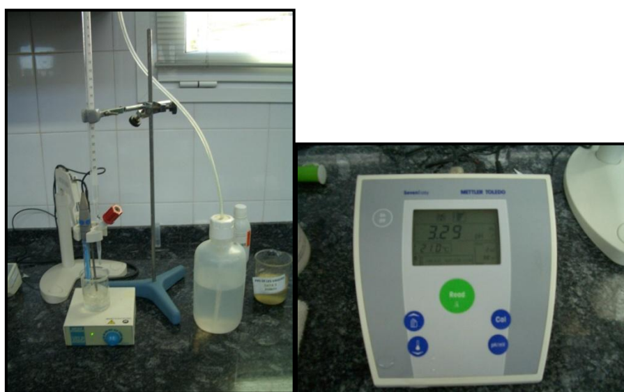
Figura 16. Imatge del procés de valoració àcid-base, amb el pH-metre al seu costat.
