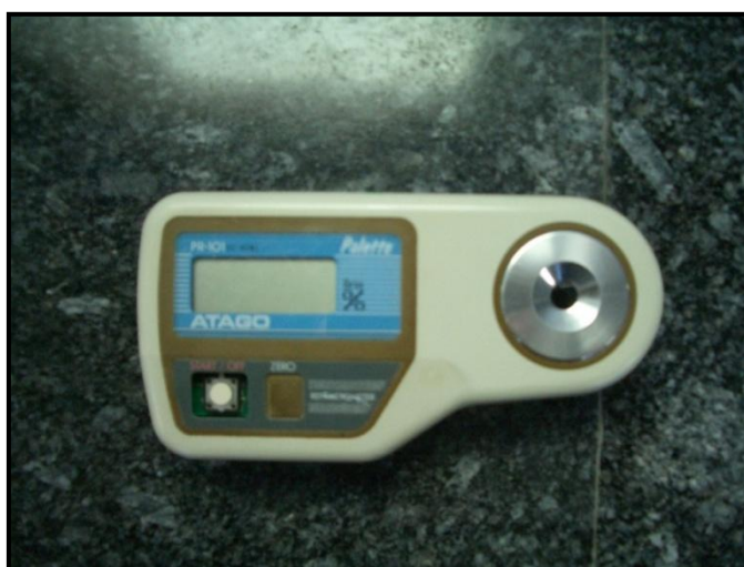
Figura 15. Imatge del refractòmetre digital que va ser utilitzat per mesurar els sòlids solubles.
