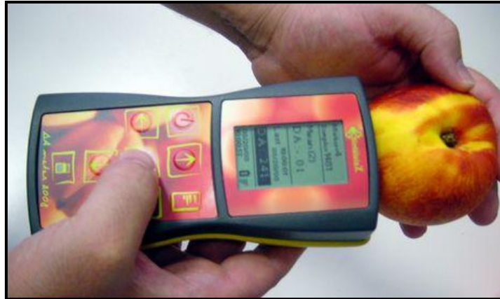
Figura 17. Imatge del DA-meter, en aquest cas mesurant l'estat de maduresa d'un préssec.
