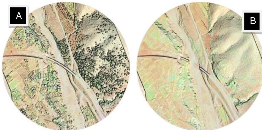
Figura 15. A) Model Digital de Superfície (MDS), B) Model Digital del Terreny (MDT). (Garcia, 2009)
