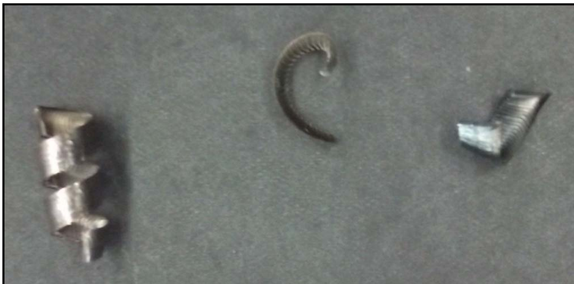
Figura no.17: Ferritja procés mecanització
