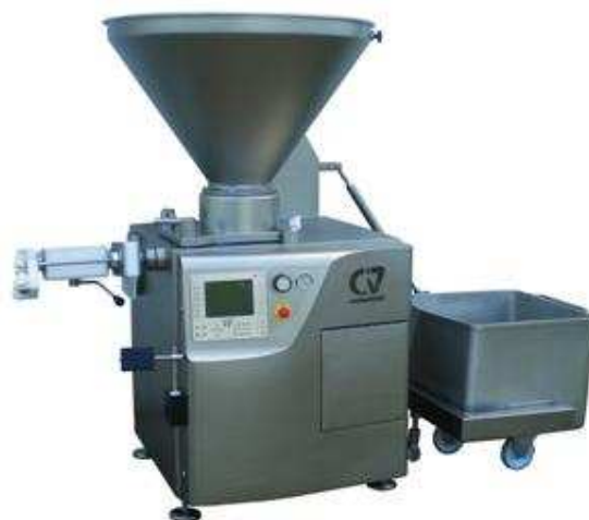
Figura 8.11. Detall d'un elevador de columna amb carro de 200 L en una embotidora(CastellVall, 2011)
