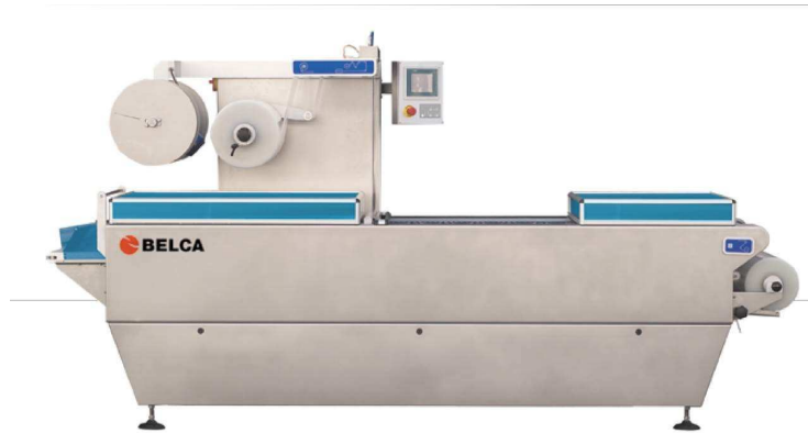
Figura 8.18. Termoformadora d'envasat automàtic (Belca, 2011)
