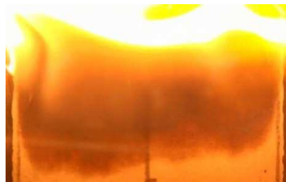
Figura 74: Franja de piròlisi per a un angle màxim d'inclinació 90° i màxima concentració d'oxigen assajada 50%
