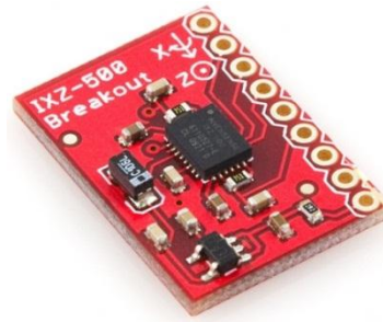
Figura 6. Placa amb el giroscòpic IXZ500 integrat
